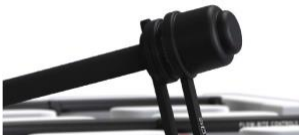
Рис. 24: Установите защитный колпачок
