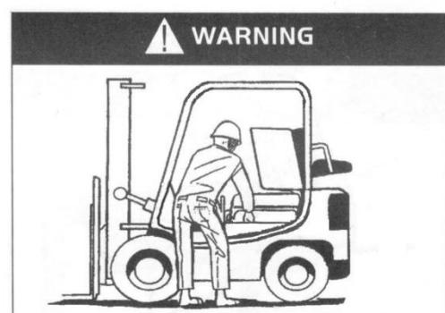
Перед началом использования проверьте погрузчик
