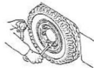
(10) Проверка момента затяжки гаек.
