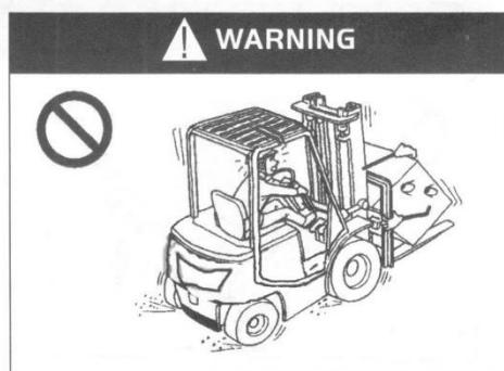
Двигайтесь плавно, избегайте внезапных ускорений и торможений
