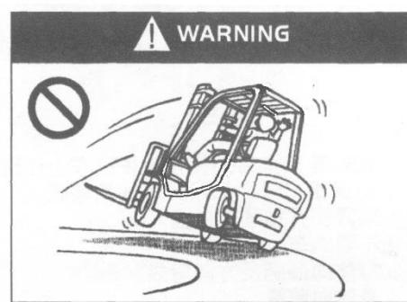
Не поворачивайте резко на большой скорости при движении с нагрузкой или без!
