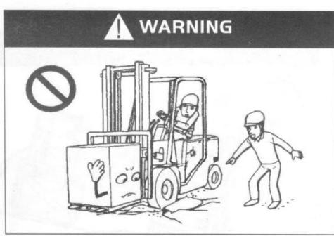
Избегайте управления по мягкому грунту, разрешено управление только по твердым ровным поверхностям.
