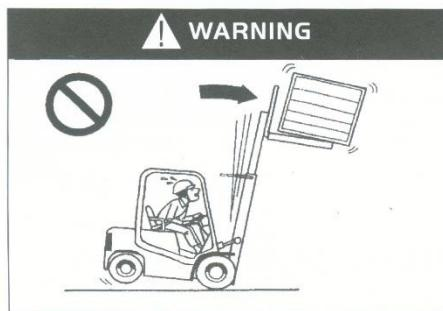
Не используйте наклон для сброса груза с вил, опасность опрокидывания
