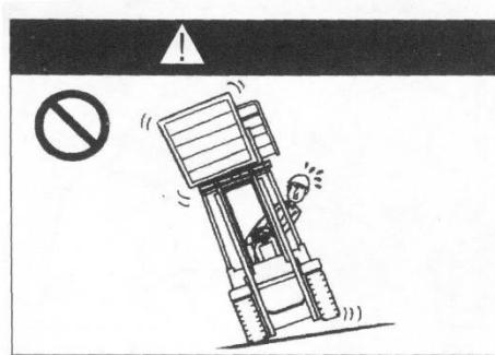
Не загружайте и не разгружайте погрузчик на наклонных поверхностях!
