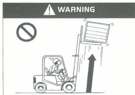
Запрещается подъем грузов при наклоненной мачте!
