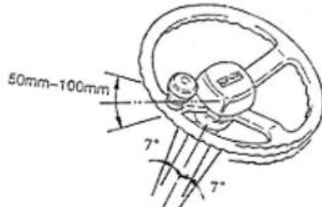
(4) Проверка работы рулевого механизма
