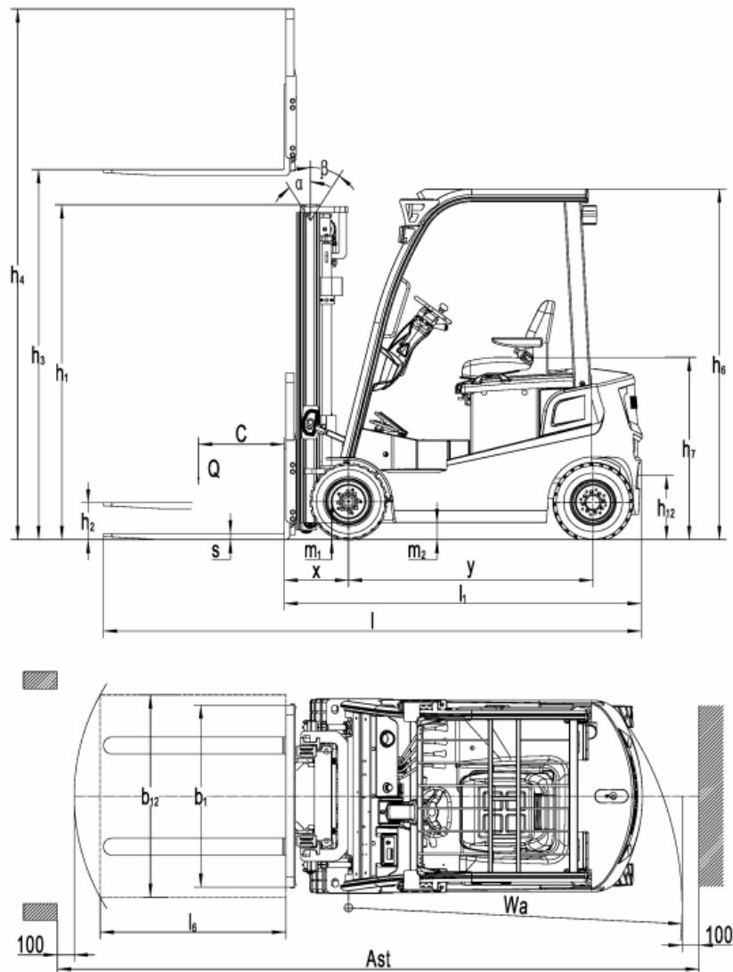
Рис. 1-1 Габаритные размеры
