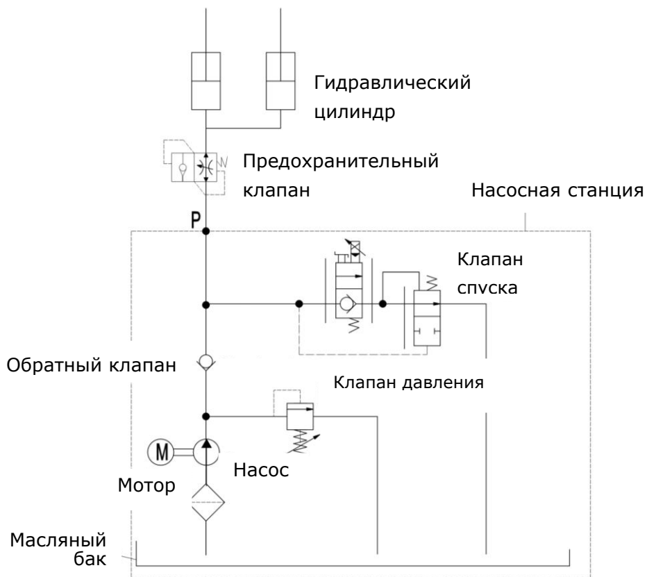
Рис. 38: Гидравлическая схема (VIBO 3,2 кВт)
