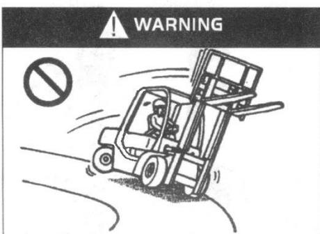
При подъеме вила без груза разрешается выполнять только развороты с малым радиусом.
