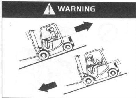
При отсутствии нагрузки двигайтесь задним ходом вверх по наклонной и передним ходом вниз по наклонной!
