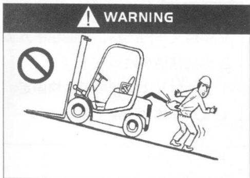
Запрещается ставить вилочный погрузчик на стоянку на наклонных поверхностях!
