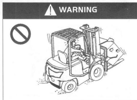
Погрузчик должен двигаться равномерно без резких ускорений и замедлений!
