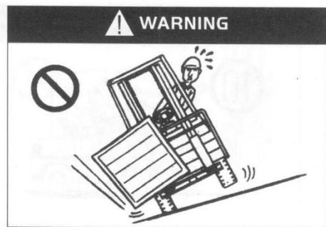
Повороты при движении по наклонной поверхности запрещены!
