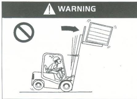
Во избежание переворота запрещается наклонять вилочный погрузчик вперед для ускорения загрузки!
