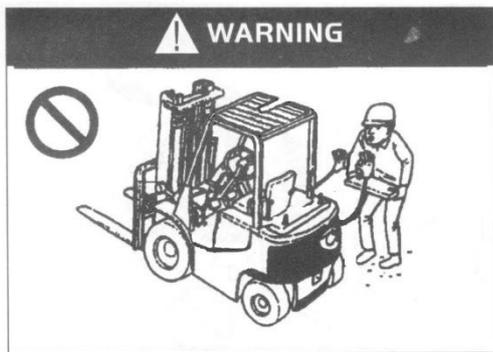
Запрещается менять детали погрузчи без предварительного разрешения.
