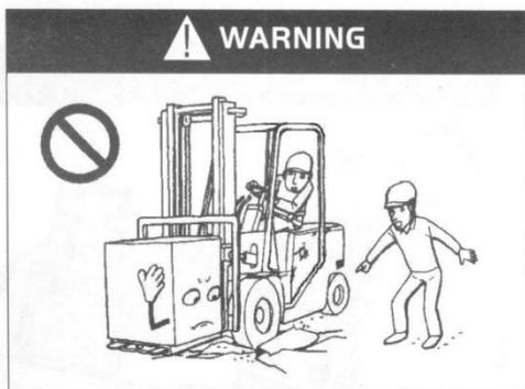
Избегайте движения по мягкому грунту. Движение допустимо лишь по твердому и ровному грунту.
