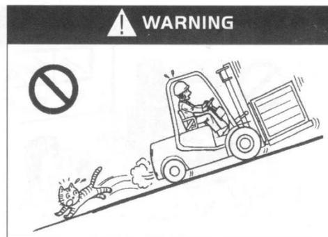
При запуске погрузчика на наклонной поверхности предварительно задействуйте тормоз!
